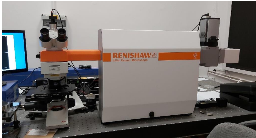
Renishaw inVia Raman microspectrometer
